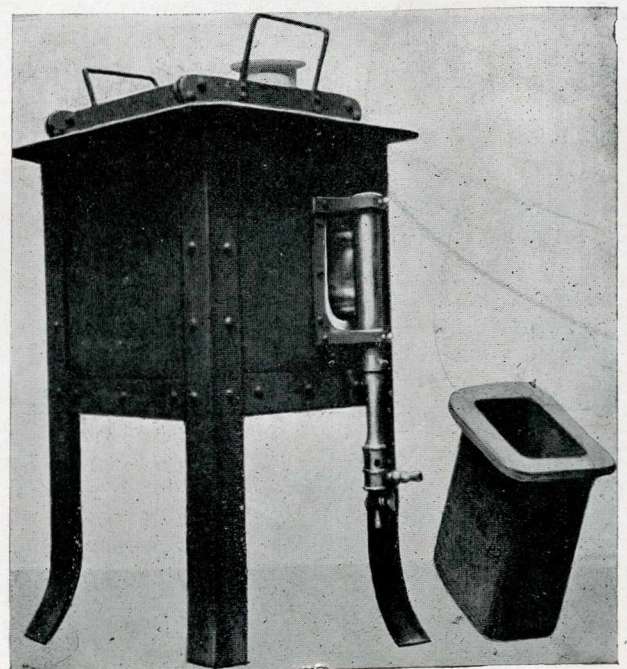
Fig. 14. — Four Tranchant à Moufle vertical pour Trempe d'Acier Rapide (1.500°).
